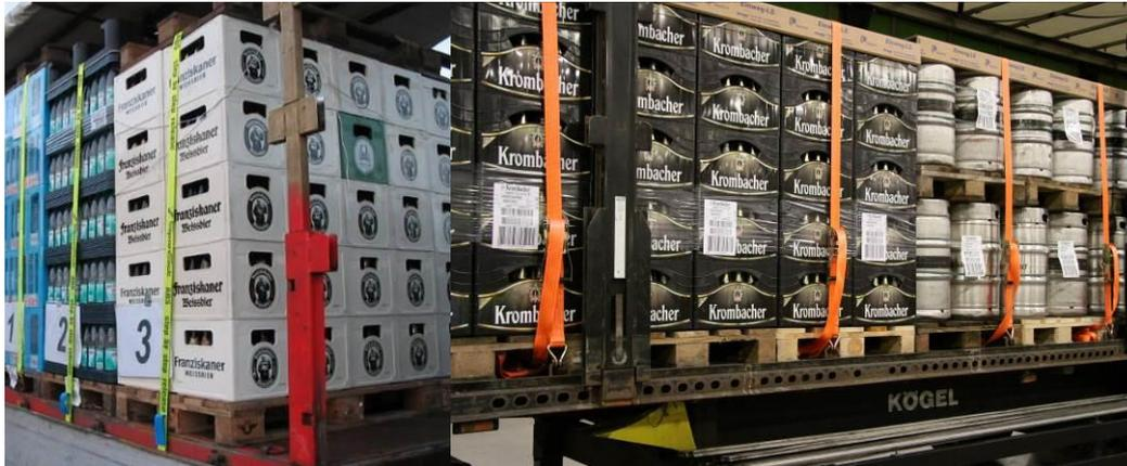
Abb. 4 & 5: Zur Stabilisierung und Zurrung sind Paletten oder geeignete Kantenschutzwinkel erforderlich. Aufgrund der Elastizität der Kunststoffkästen muss hierbei eine Holzpalette oder ein anderes Hilfsmittel zur Kräfteinleitung des Zurrmittels in die Ladeeinheit von oben benutzt werden. Auch Fassladungen können derartig gesichert werden.
