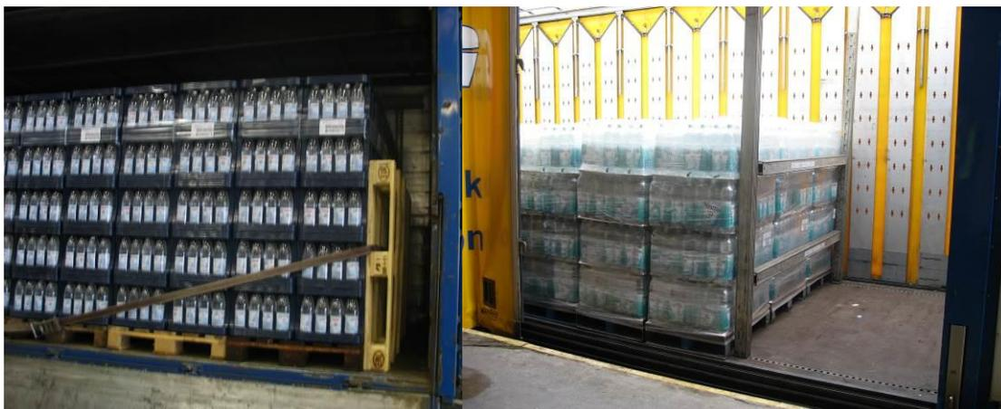
Abb. 6 & 7: Kopflashing für rückwärtige Sicherung und feste Balkensysteme
