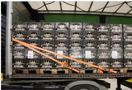
Abb. 3: Absicherung der Stirnwand
