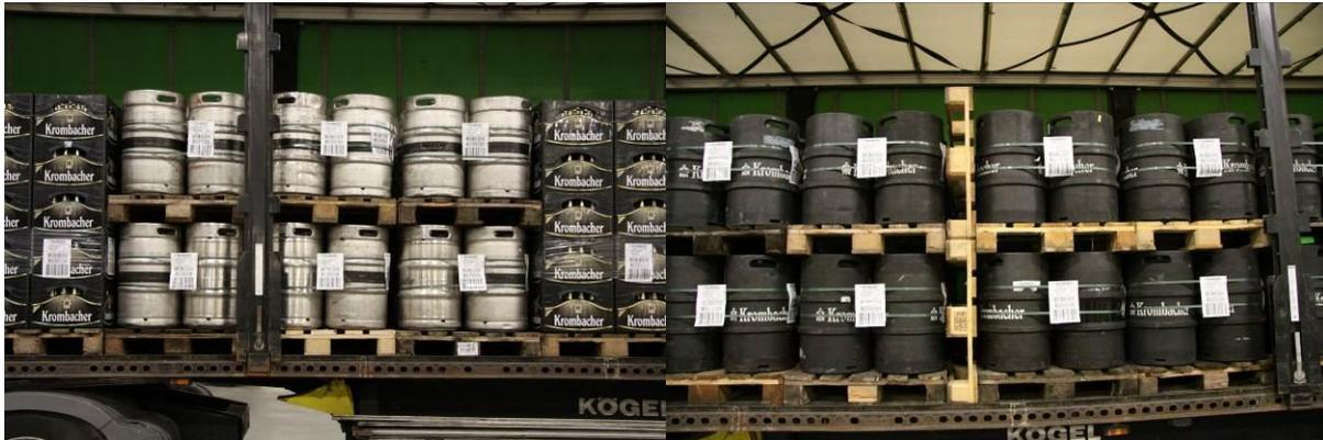
Abb. 1: Sinnvolle Anordnung für Mischladungen (Bildung „formschlüssiger Gefache“ durch Kastenware für nicht mehr als 6 X 6 Stahlfässer in der Grundfläche)      Abb.2: Bei Fass-Vollausladungen können Paletten helfen
